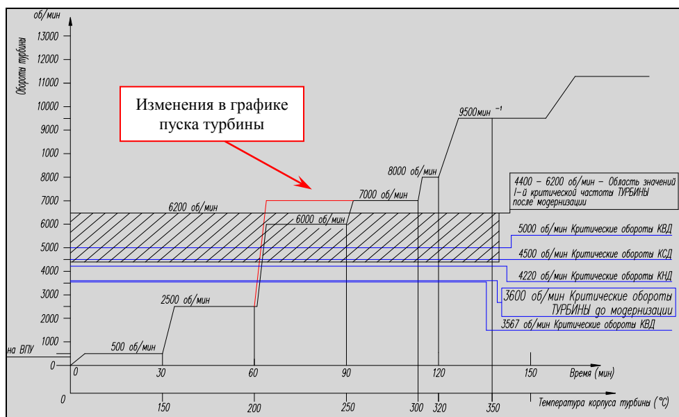
Рисунок 11 - График пуска турбины Р32/15-9,9/4,1 поз. 401 со внесенными изменениями
